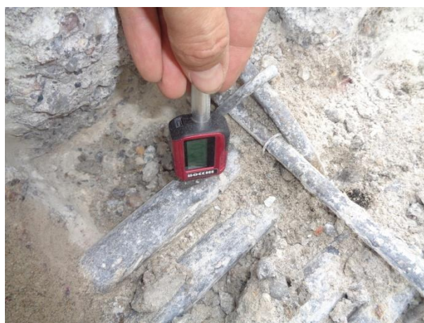
Esecuzione di prove con durometro
