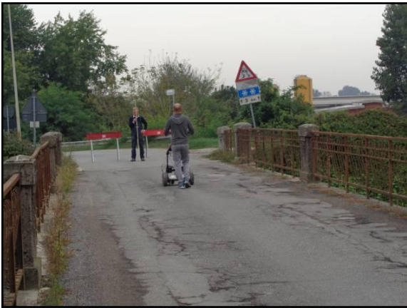
Antenna carrellata da 200-600 MHz durante la fase di acquisizione
