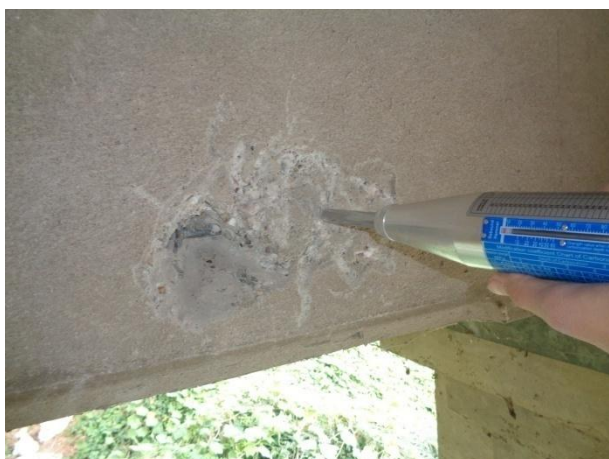
Esecuzione prove sclerometriche
