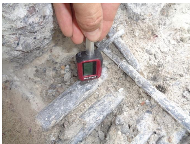
Esecuzione di prove con durometro
