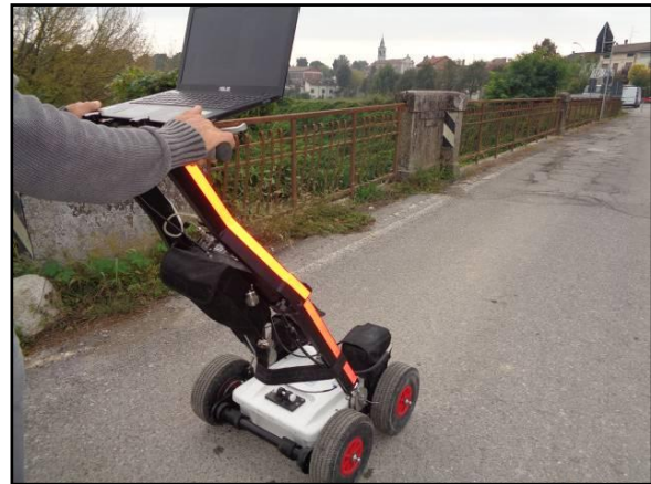
Antenna carrellata da 200-600 MHz durante la fase di acquisizione
