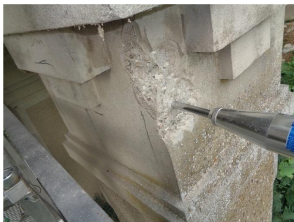
Esecuzione prove sclerometriche
