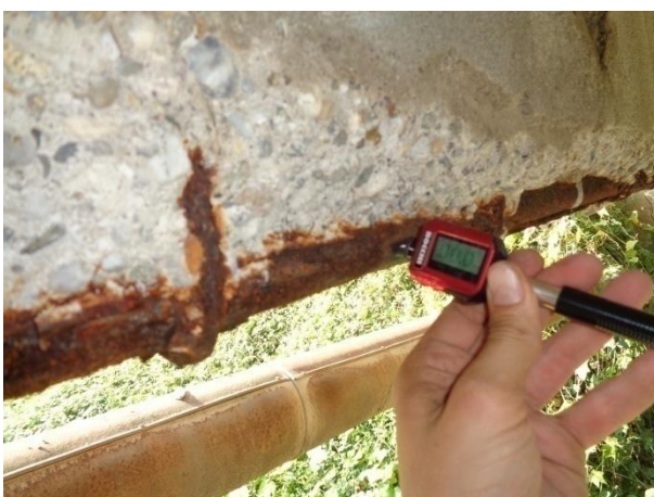
Esecuzione di prove con durometro
