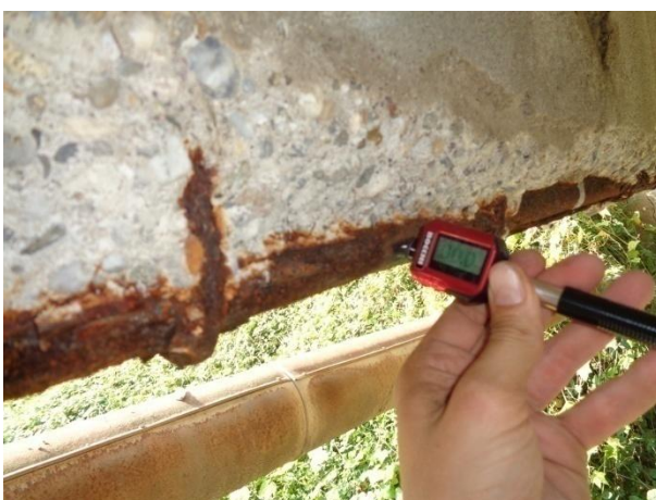
Esecuzione di prove con durometro
